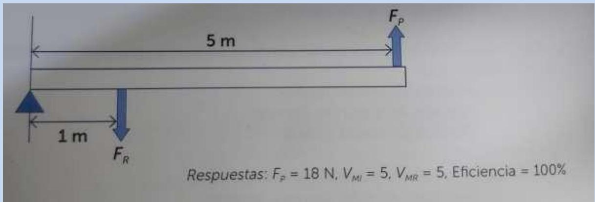
3. En la siguiente figura, determina el largo de la palanca para  $F_p=30 \text{ N}$ , colocando a 1 m de distancia del fulcro un peso 90 N, además determina  $V_{MP}$ ,  $V_{MR}$  y la eficiencia del sistema (e).
