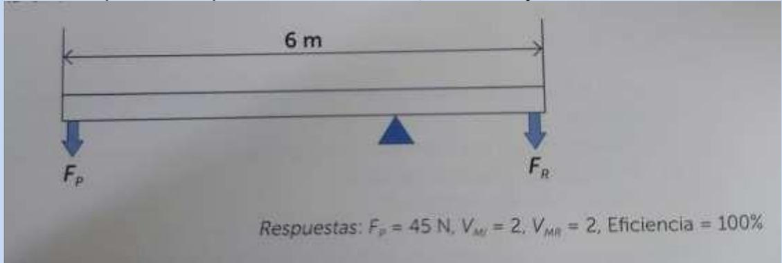
2. Se tiene en el extremo izquierdo de una palanca 5 m, un fulcro y aun un 1 metro de distancia del fulcro se coloca un peso de 90 N, como se muestra en la figura, determina:  $F_p$ ,  $V_{MP}$ ,  $V_{MR}$  y la eficiencia del sistema (e).
